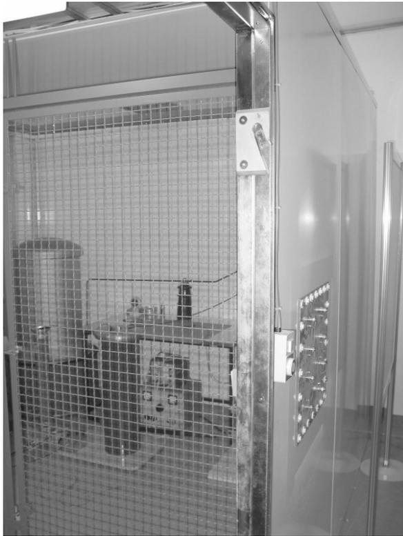
Geschirmte Meßkabine mit integriertem Meßplatz zur Teilentladungs- und Verlustfaktormessung (Grundstörpegel  $< 0,2 \text{ pC}$ ), Durchführung von Praktika zur Teilentladungs- und Verlustfaktormessung sowie zur Untersuchung des dielektrischen Verhaltens von Isolierstoffen
