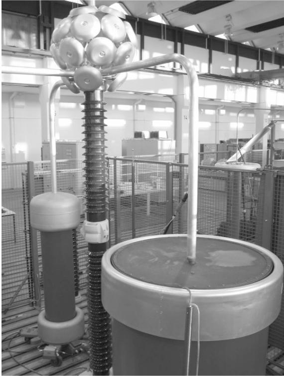
Wechselspannungs-Prüfsystem bis 200 kV mit modernisierter Computersteuerung, geeignet z.B. für die Durchführung des FGH-Stufentests an Kabelproben, Dieses wird auch für Prüfaufgaben von regional ansässigen Unternehmen genutzt.
